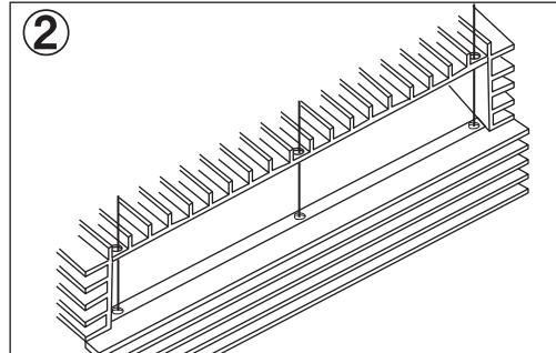
ケース蓋部分をハードディスクが取り付けられたケース下部に被せて下さい。(ケース蓋部分のネジ穴とケース下部のネジ穴が重なる様に被せて下さい。)
