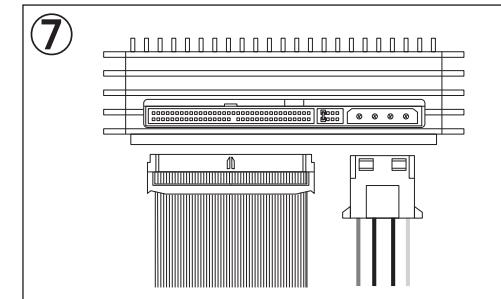
最後にご使用になるハードディスクの種類のケーブルをHDDに取り付けて下さい。
