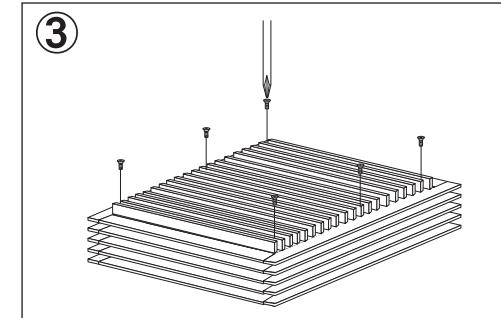
ケース固定用ネジ6本を用いてケース蓋部分とケース下部を固定して下さい。
