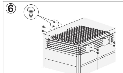
パソコンケース取り付け用ネジを用い氷室本体をパソコンケースに固定して下さい。(ネジを強く締めすぎると本体内部の金属部分がゴム部分より剥離する恐れがあります。)
