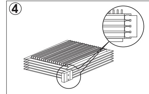
図を参照して、防振ネジ受け4つを氷室本体に装着して下さい。硬質タイプ防振ラバー付きネジ受けの取り付け位置は、お客様のご使用しているパソコンケースや収納方法によって取り付け場所を換えて下さい。
